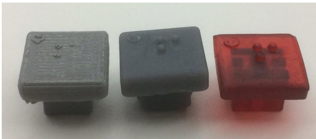
Рисунок 7. Разные технологии печати.
